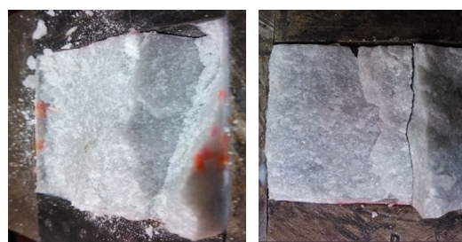
图 16 直接剪切试样破裂面
